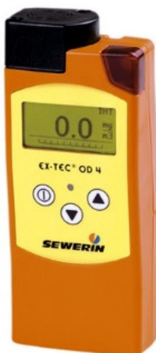
Como medida de seguridad, odorizantes como el Tetrahidrotiofeno (THT) o el Tetrabutylmercaptano (TBM) son inyectados a la red de distribución de gas. En caso de fuga, son éstos compuestos los que alertan sobre la misma.
